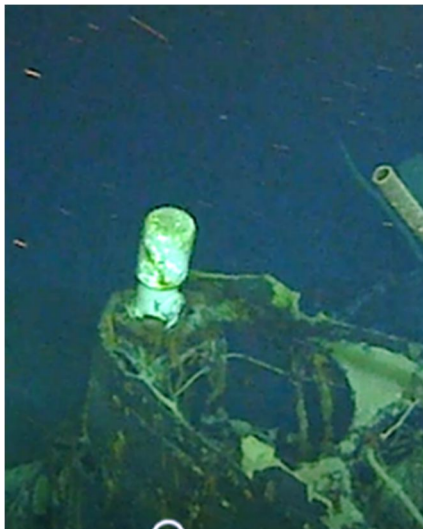
Base fixe VLF, emplacement du sas APV et découpe du carénage supérieur
